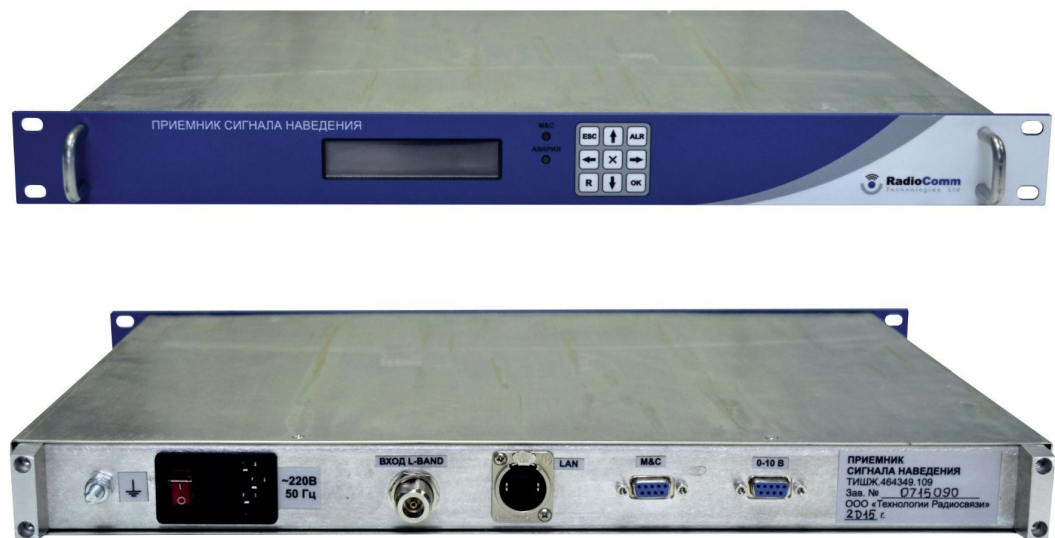
Рисунок 1.2.1 – Внешний вид приемника наведения ПСН
